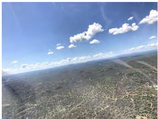
Weitere fliegerische Herausforderungen in dieser Gegend sind auch die Density Altitude (Temp. oft über 30°C, Durchschnittshöhe in dieser Gegend über 1000m, Flughöhe 3740ft), und magnetische Kompassabweichung von 18° (Vergleich: in A ca 3-5°, also nicht relevant)
