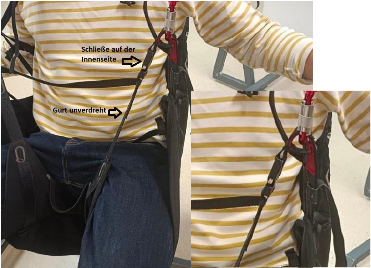
✓ Abbildung 2 und 3: Korrekter Verlauf der Beingurte und korrekter Verschluss der Schließen
