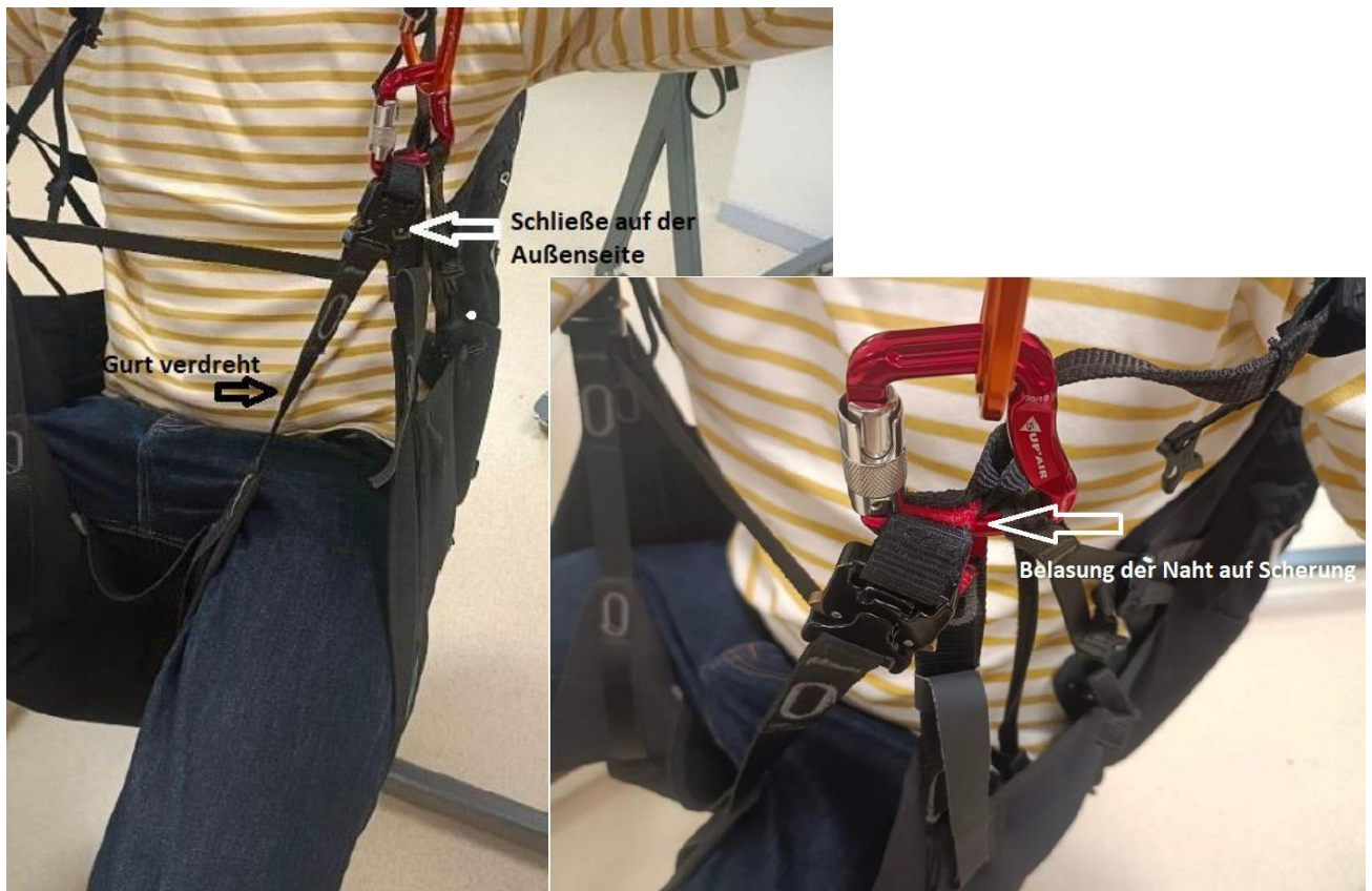
✗ Abbildung 4 und 5: Fehlerhafter Verlauf der Beingurte und nicht korrekter Verschluss der Schließen
