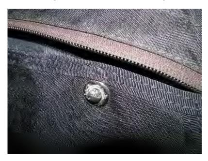
Abbildung: Die Metallöse mit den Korrosionsspuren und dem verhärteten Loop
