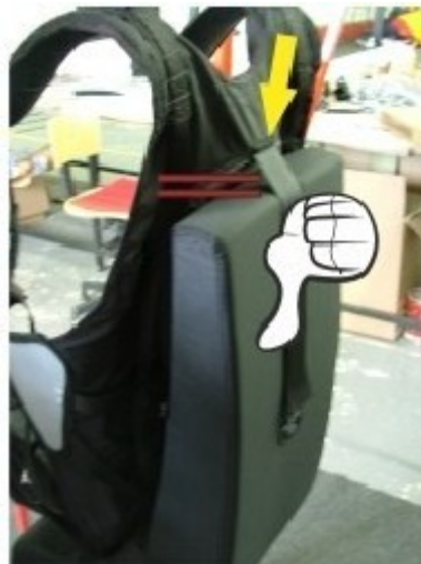
Abbildung 2: Fehlerhafte Fixierung des Protektors. Das Klettband der Fixierung ist so angebracht, dass der Protektor, bei Belastung, nach oben geschoben werden kann.
