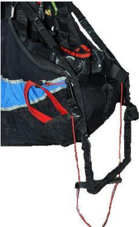
Bild 1: Beschleuniger (rot) und Beinstrecker (schwarz) in entlasteter Stellung (Beschleuniger in Tragegurte eingehängt).
