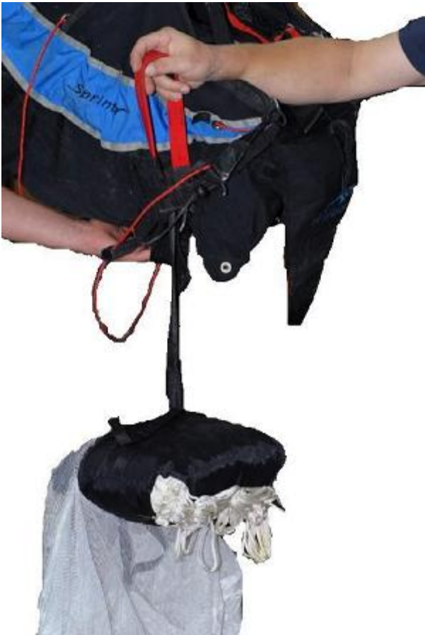
Bild 3: Bei Auslösung des Rettungsgerätes kann dieses durch den Beschleuniger/Beinstrecker fallen.
