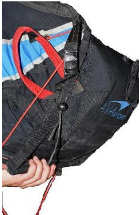
Bild 2: Bei ungünstiger Anströmung können Beschleuniger und Beinstrecker unter die Containeröffnung gelangen.
