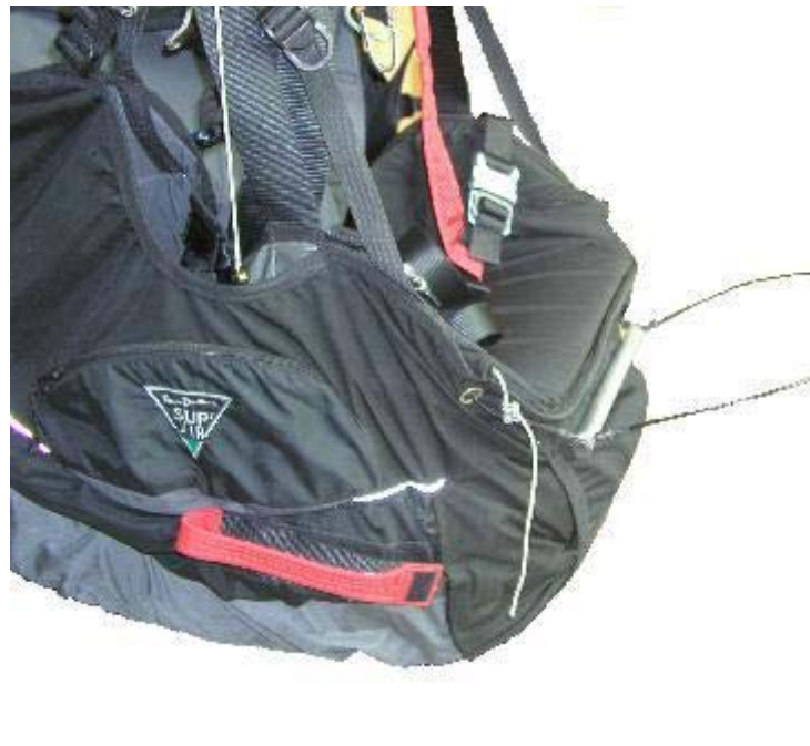
Bild 6: Richtige Position des Fußbeschleunigers. Im entlasteten Zustand befindet sich dieser an der Sitzbrettvorderkante und behindert die Rettungsgeräteauslösung nicht.
