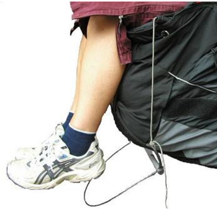
Bild 5: Falsche Position des Fußbeschleunigers. Durch fehlerhafte Einstellung befindet sich der Beschleuniger vor der Öffnung des Rettungsgeräte-Außencontainers.
