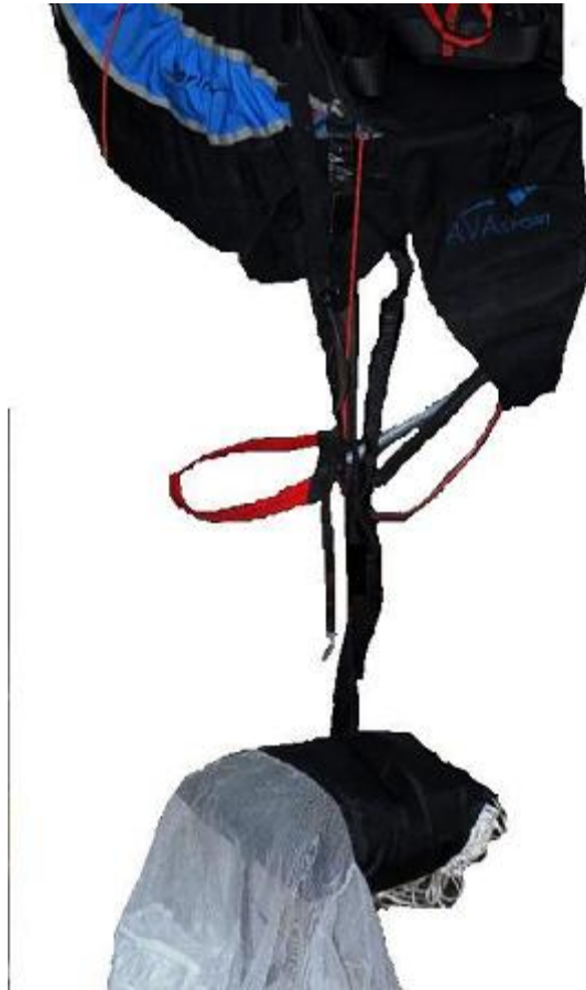
Bild 4: Der Innencontainer kann sich in Beschleuniger/Beinstrecker verhängen. Dies kann die Auslösung des Rettungsgerätes verhindern oder zu einer unkontrollierten Auslösung führen.
