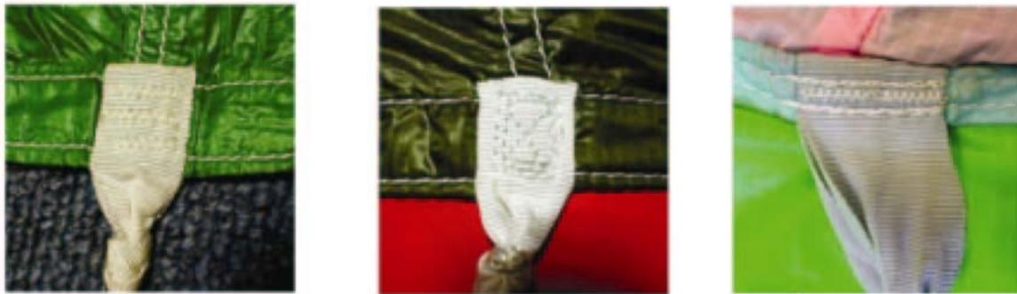
Diese Vernähungen sind unkritisch und dementsprechend nach der Überprüfung wieder für den Betrieb zugelassen. Der Reservefallschirm ist in diesem Fall mit der Bezeichnung „BS PdF No2-2003 Airworthy“ auf dem Typenschild zu versehen. Die Überprüfung ist entsprechend zu dokumentieren. und auch auf dem Packnachweis einzutragen
