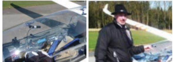
Gerold Auerbach stellte sein Multi-Videosystem zu Testzwecken zur Verfügung. 3 Kameras im Cockpit sind auf das Instrumentenbrett, nach vorne und in Richtung zum Gesicht des Piloten gerichtet. Auf diese Weise können gewisse interessante Situationen dokumentiert und analysiert werden.
