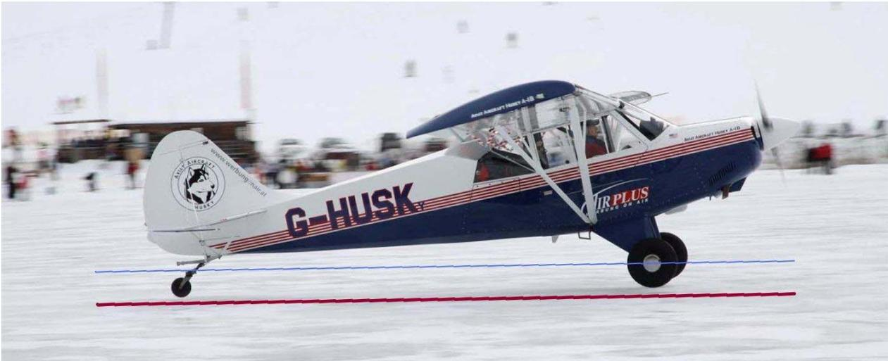
korrekte Landung mit Spornradmaschine
