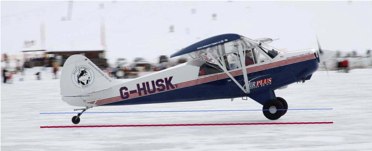
korrekte Landung mit Spornradmaschine
